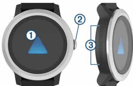
① **Pantalla táctil:** desliza el dedo hacia arriba o hacia abajo para desplazarte por los widgets, las funciones y los menús. Tócala para realizar selecciones.
