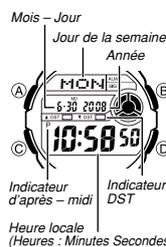
Cette montre reçoit un signal d'étalonnage de l'heure et règle l'heure en conséquence.
