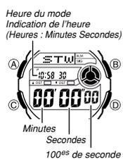
Le chronomètre permet de mesurer le temps écoulé, des temps partiels et deux arrivées.
